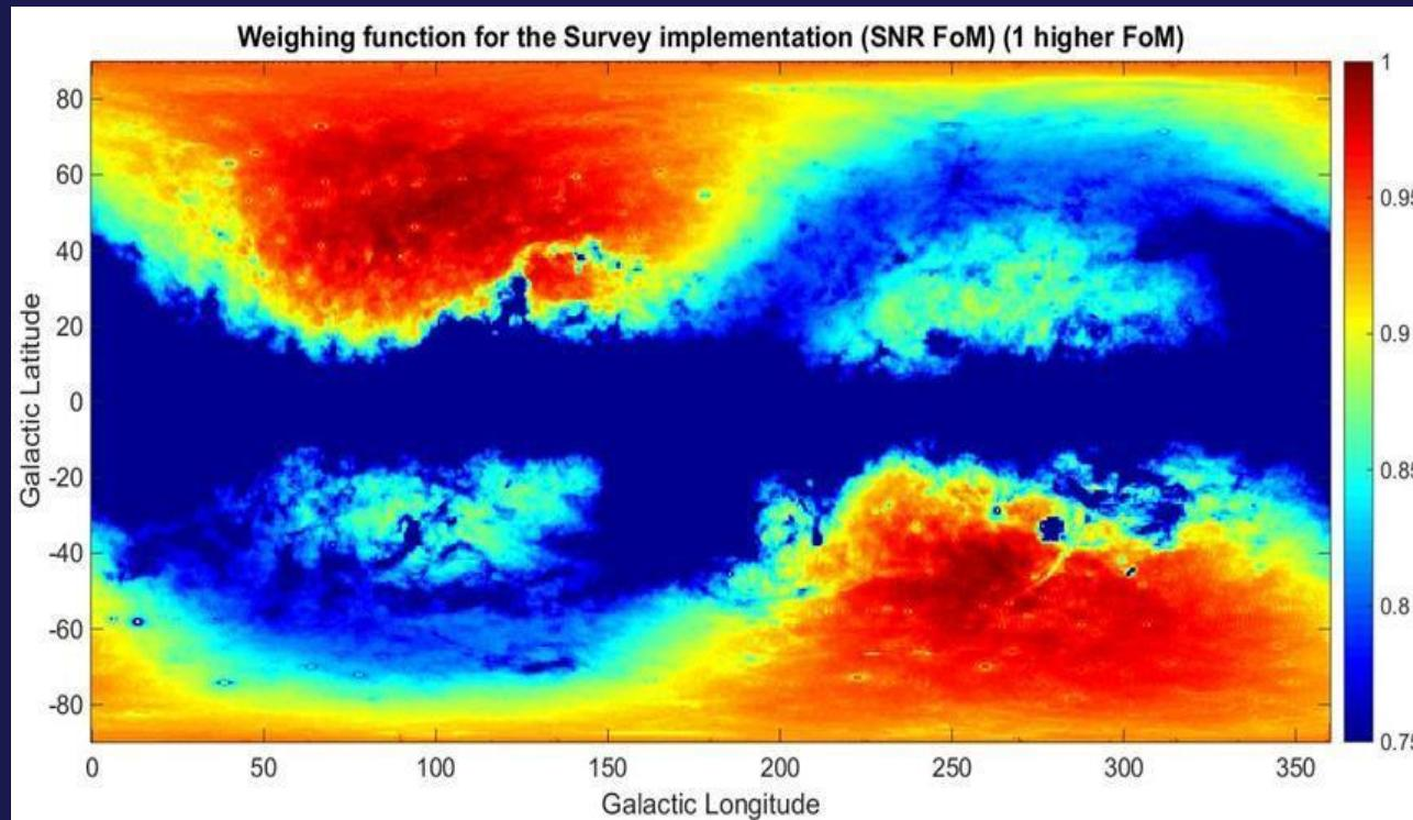
A partir du point de fonctionnement du Satellite, estimation des performances intégrées sur le ciel avec des conditions variables (straylight, zodiacal background, star densities,...).
