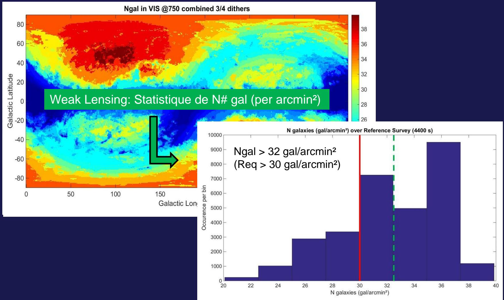
A partir du point de fonctionnement du Satellite, estimation des performances intégrées sur le ciel avec des conditions variables (straylight, zodiacal background, star densities,...).
